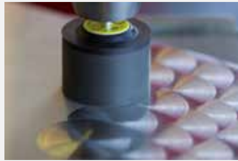
Beispiel für einen Zierschliff mit R-Flex Marmorierkörper SFM 656 auf Edelstahlblech
